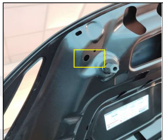
Bild 2: Neuteil: Fehlende Gewindehülsen
