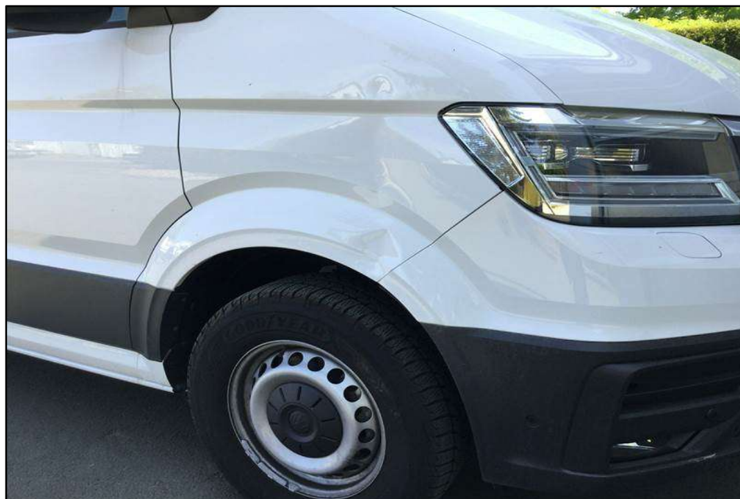
Bild: 1 VW e-Crafter mit Beschädigung Kotflügel vorne rechts
