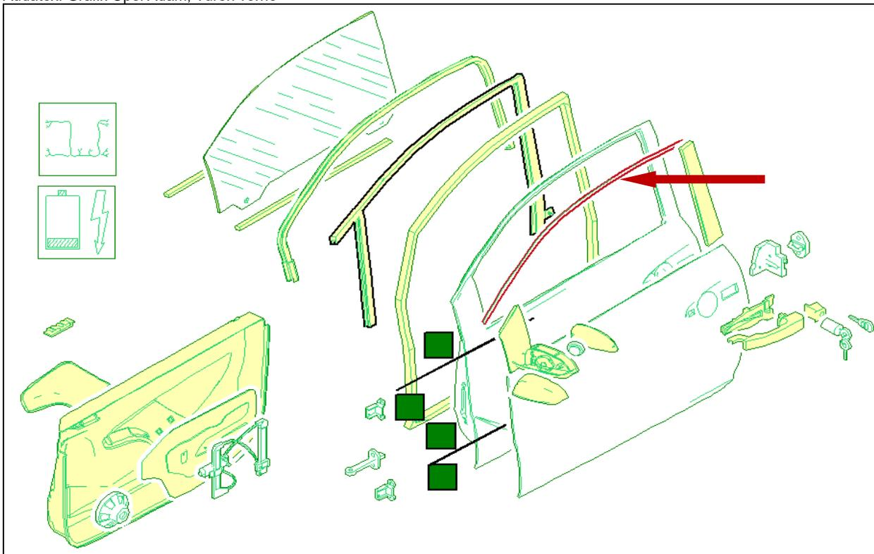
Die Fensterabdichtungen sowie die Türdichtungen türseitig sind zerstörungsfrei demontierbar und können wiederverwendet werden. Lediglich die Clipse, mit denen die Türdichtungen befestigt sind, können beschädigt werden. Diese sind einzeln bestellbar und können ersetzt werden – Teilenummer: 11611342 (aktuelle Teilenummern entnehmen Sie bitte stets dem Ersatzteilkatalog des Herstellers).
