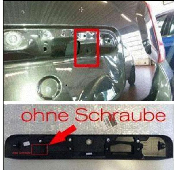
Bild 4: Neue Heckklappe 90 10 031 01R (Bildquelle: Dacia)
