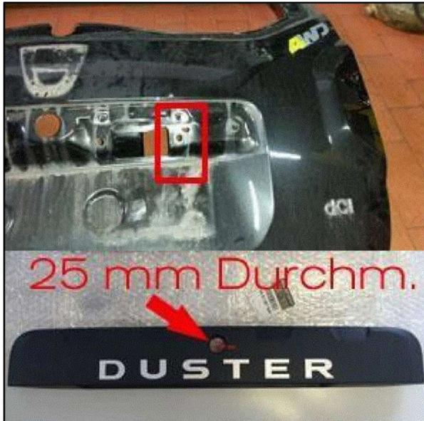
Bild 3: Original verbaute Heckklappe (Bildquelle: Dacia)
