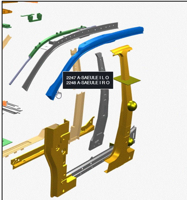
Bild 1: Grafik Qapter Audatex, Verstärkung A-Säule ILO
